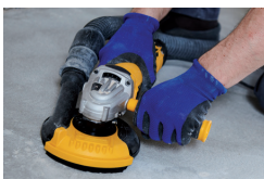
Machine équipée d'une aspiration
