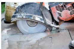
Machine avec système d'abattage à l'humide
